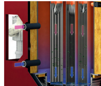
Economii suplimentare de energie datorită separării retururilor
